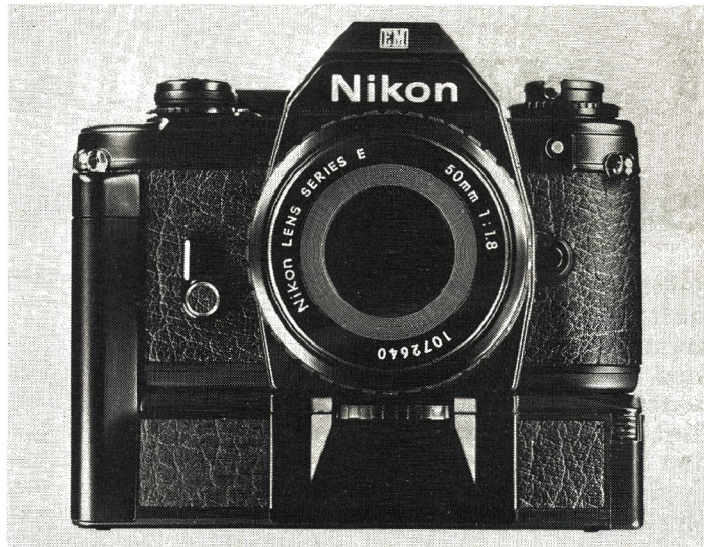
Motoren vejer kun 185 gram. Dertil kommer 6 små AAA-batterier. Selv med de gode alkalibatterier på 12 gram bliver totalvægten kun 255 gram.
